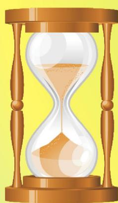
Песочные часы представляют собой два небольших сосуда, имеющих форму конусов, соединенных вершинами друг с другом, с узким отверстием в месте соединения сосудов. В верхнем сосуде находится песок, который тонкой струйкой просачивается сквозь отверстие в нижний сосуд. Когда весь песок из верхнего сосуда окажется в нижнем, проходит определенное время, например, одна минута.
